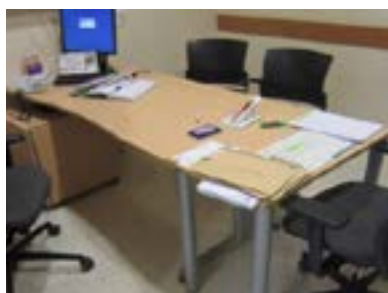
Extensión de mesa que impide la maniobra a personas usuarias de silla de ruedas.
