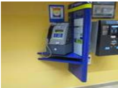
Teléfono. Inaccesible y sin proyección horizontal.
