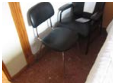
Espacio insuficiente de transferencia a la cama.
