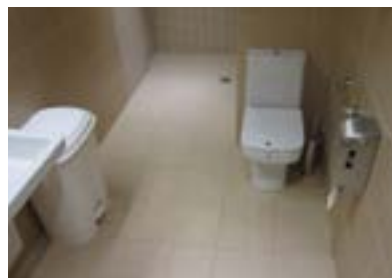
Baño tipo. Hospitalización paritorio. No permite giro a personas usuarias de silla de ruedas y no dispone de ayudas técnicas.
