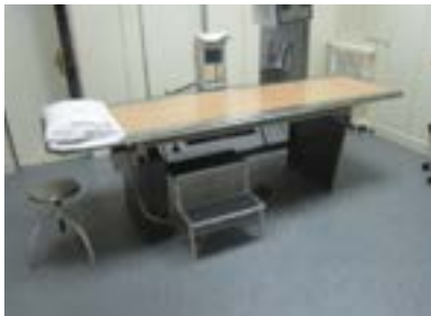
Camilla de radiología. Altura mínima de la plataforma 78,5 cm. Inaccesible.
