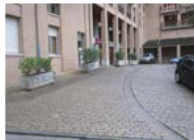
Sarrera nagusirako sarbideko malda. Eskubandarik gabe eta zoladura irristakorra. Eredu honetan, ez dago ezinduei gordetako aparkalekurik.
